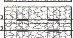
Susedné gabiony sa dosýpajú naraz, aby sa zabránilo možným deformáciám. V prípade ukladania viacerých gabionov na seba je vhodné spodný rad neprepínať, skôr naopak – nedopĺňať. Pre zachovanie tvarovej stability gabionovej konštrukcie pri plnení kamenivom sa hned po rozmiestnení dištančných tiahiel pripievajú k lícevej, rubovej strane a priečkam debniace prvky – debniace prefabrikáty, alebo lešenárske trubky.
